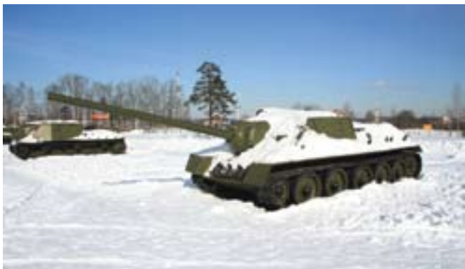
Самоходная артиллерийская установка СУ-100 (боевая масса - 31,6 т, экипаж - 4 чел., вооружение - 100-мм пушка и один пулемет, скорость движения - 48 км/час, запас хода - 310 км)
