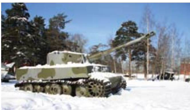
Трофейный немецкий тяжелый танк Т-VI "Тигр" (боевая масса - 56,8 т, экипаж - 5 чел., вооружение - 88-мм пушка и два пулемета, скорость движения - 38 км/час, запас хода - 140 км)
